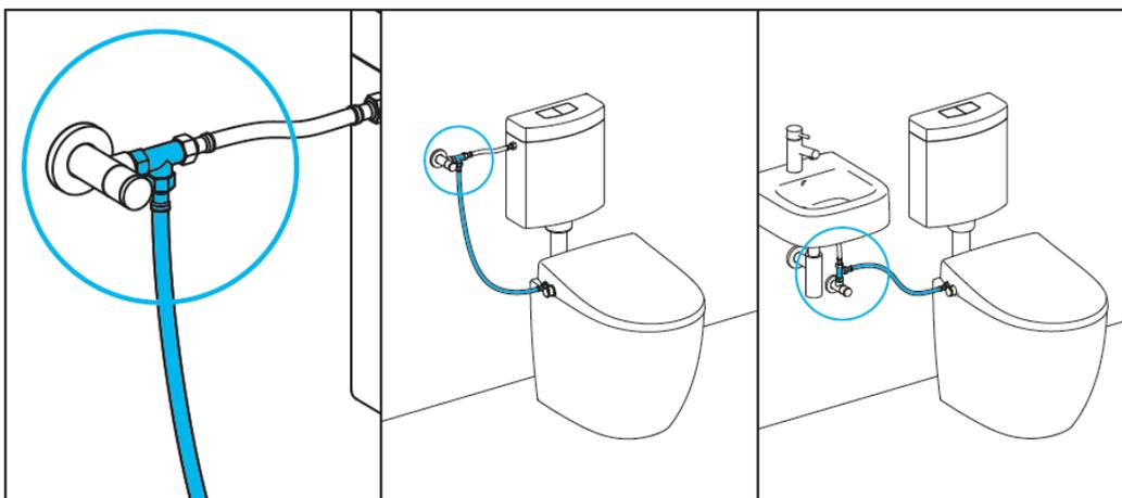
Anschluss am Eckventil, Spülkasten oder Waschbecken. Anschlusszubehör (T-Stück und Anschlussschlauch) im Set enthalten. Hinweise auf der Montageanleitung beachten..
